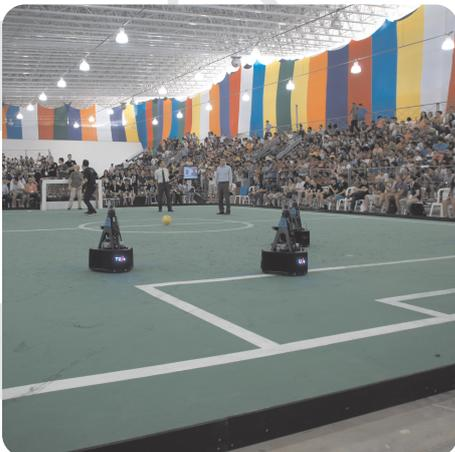
Auf diesem Bild sieht man die Demo Humans against Robots der Midsized League. Bei dieser Liga fahren die Roboter auf Rädern um den Forschungsschwerpunkt auf die Taktik der Roboter zu legen und weniger auf die Fortbewegung. Schon heute konnten die Roboter in dieser Liga gegen das Menschliche Team bei der Demo ein Tor schießen.
