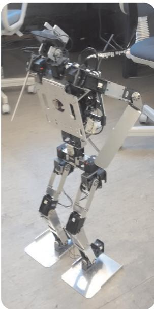
Die Roboter müssen gewisse Körperproportionen einhalten und dürfen nur menschliche Sensoren benutzen. Eine Ausnahme ist die Kommunikation über WLAN zwischen den Robotern. Es dürfen bis zu zwei Kameras mit einem stark überlappendem Bild eingebaut werden. Kameras, die Tiefeninformationen bereitstellen, wie zum Beispiel die Kinect, sind verboten. Die Roboter müssen komplett autonom handeln.
